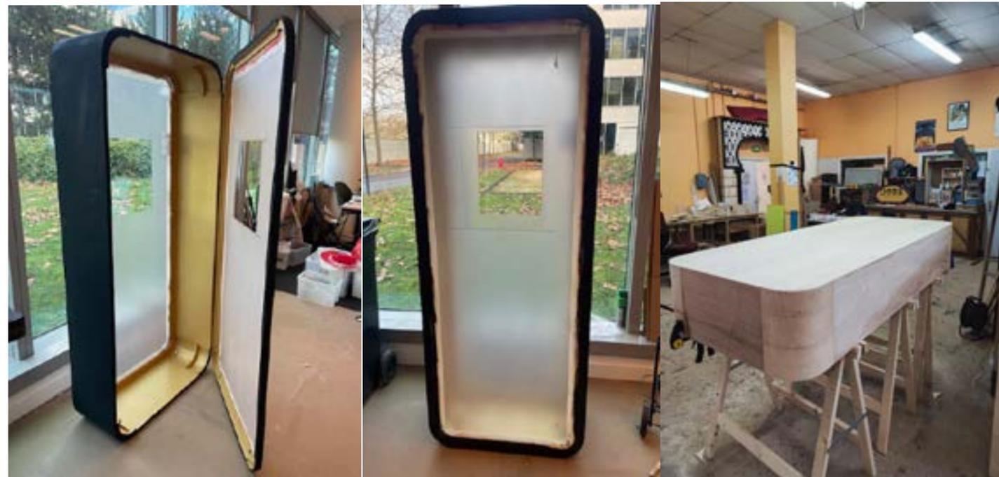
Dispositif téléphone en bois dimensions 1M80 /80 cm/ 30cm de large.Ce téléphone va servir de gabarit et enveloppé de plaques offset.
